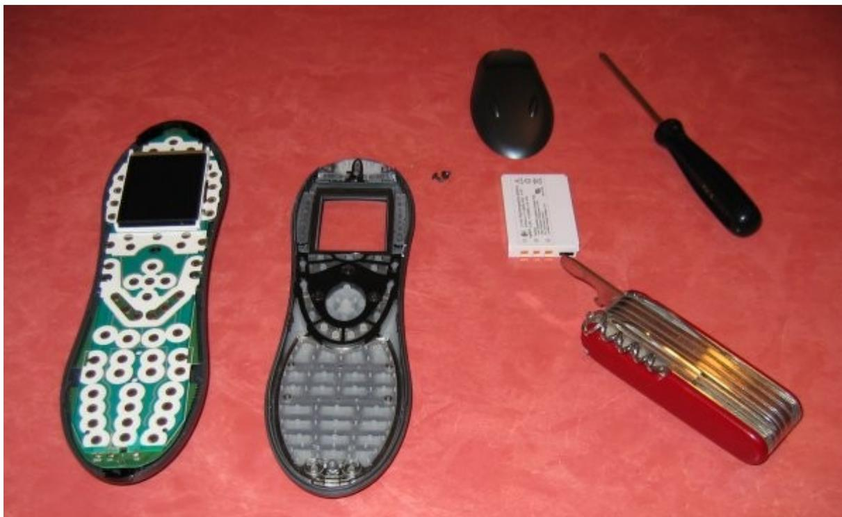
Maintenant séparez la plaque d'époxy comportant les contacts des touches ainsi que l'écran LCD du panneau arrière de la télécommande mais attention vous allez devoir débrancher le connecteur reliant le circuit de la télécommande aux contacts de recharge situés sur le panneau arrière.
