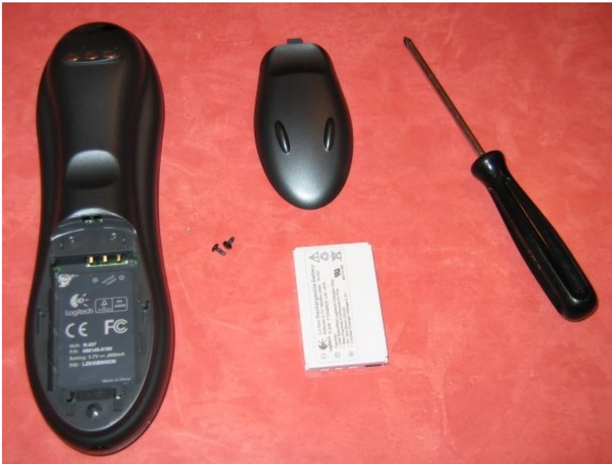
Avec le couteau il va falloir déclipser la télécommande. Sur la photo suivante vous pouvez voir que chaque coté de la télécommande comporte quatre clips qu'il va falloir ôter un à un.
