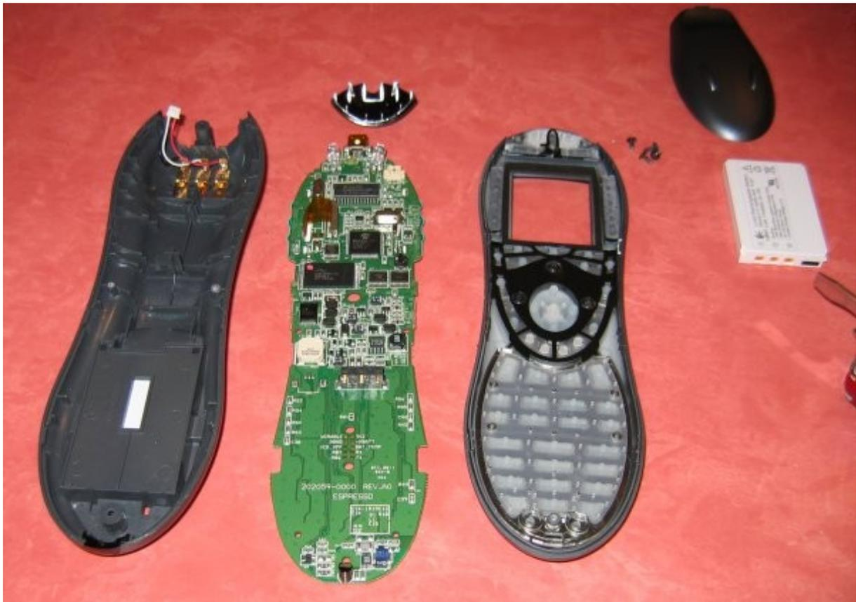
Etape 3: Localisation, démontage, nettoyage et remontage du détecteur de mouvement:
